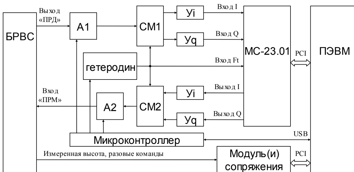
Рис. 2. Структура комплекса ПНМ на базе модуля ЦОС MC23.01
